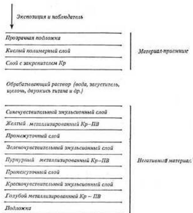
Рис. 36. Схема цветного одноступенного процесса SX-70.
